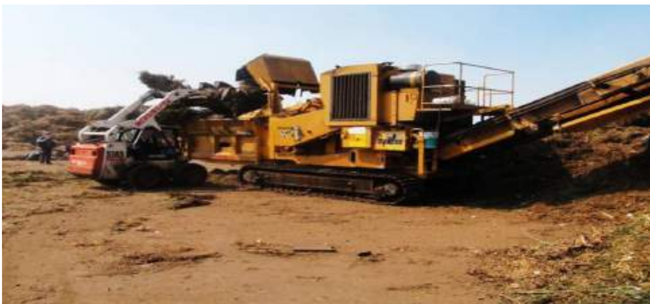
Operación de equipo de trituración del producto de poda de áreas verdes
